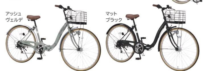
MC509 フレーム: スチール 幅55×長さ178×高さ98~102cm 収納時: 幅36×長さ90×高さ75cm 18kg 耐荷重75kg シマノ6段ギア LEDオートライト・リング錠・カゴ付 [中国製]
